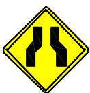
A-21 a Estreitamento de Pista ao Centro
