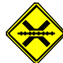
A-39 Passagem de Nível sem Barreira
