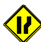
A-21 e Alargamento de Pista à Direita
